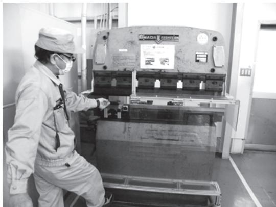
写真4 従来使用していたベンディング加工機
